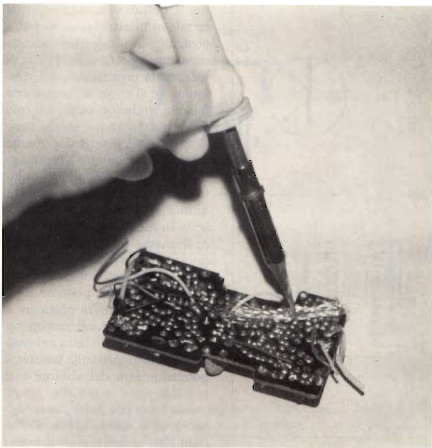
Dissaldatura per mezzo della calza di rame.
